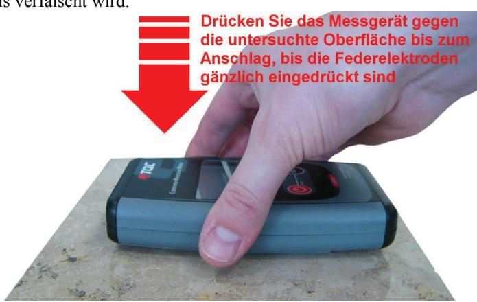
Aufgrund der Tendenz zur einer ungleichmäßigen Feuchtigkeitsverteilung im aushärtenden Beton empfiehlt es sich, mehrere Messungen an dicht aneinander liegenden Stellen vorzunehmen.
