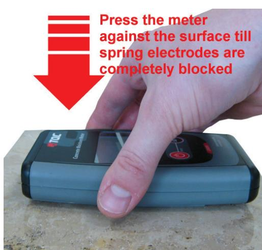
Il est recommandé d'effectuer quelques mesures dans les points prochains les uns des autres, étant donné qu'il y a la tendance à la distribution non uniforme de l'humidité dans le béton en train de son séchage.
