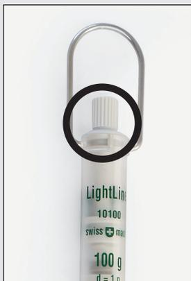
**Taratura / Lettura:** Applicare una vaschetta per campioni vuota e pulita. Regolare il punto zero ruotando la vite di taratura bianca (cerchio nero). In tal caso gli occhi devono essere all'altezza della scala graduata al fine di minimizzare errori di lettura.
