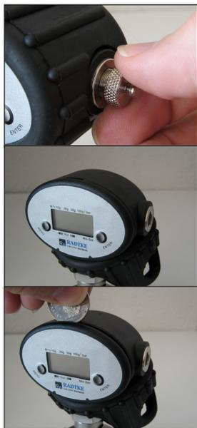
A tale scopo è necessario svitare la copertura dell'interfaccia e sfilare il cappuccio di protezione in gomma.
