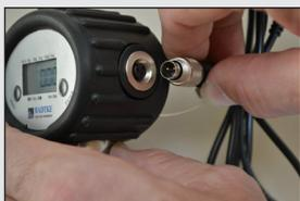
Collegare il cavo anche al manometro e attivare il comando **Print** sul manometro. Potete stampare tutti i protocolli che volete dell'ultima misurazione.
