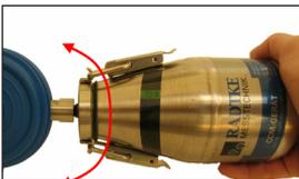
La misurazione è terminata quando la pressione è costante. Ciò dipende in gran parte dall'intensità dello scuotimento e, secondo il materiale campione, è tipicamente richiede 10 minuti (timer). A scopo di controllo la bombola a pressione viene nuovamente agitata brevemente. Se la pressione rimane invariata, la misurazione può essere considerata terminata.
