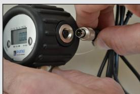
Raccordez également le câble sur le manomètre puis lancez la commande PrInt sur le manomètre. Vous pouvez imprimer autant de rapports de la dernière mesure que vous le souhaitez.
