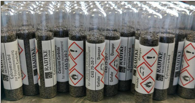
Détermination de l'humidité
