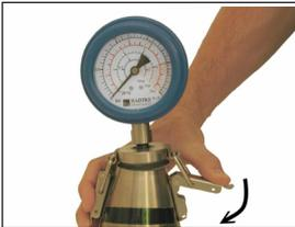
Refermez la bouteille de pression avec le couvercle. Réglez la minuterie (jointe à l'équipement CLASSIC) sur 10:05 (minutes:secondes), démarrez-la et agitez vigoureusement la bouteille de pression jusqu'à atteindre les 10:00. La réaction chimique démarre une fois l'ampoule concassée.
