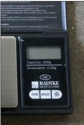
Au bout de 120 secondes, la balance se désactive automatiquement; vous pouvez également appuyer sur la touche ON/OFF pendant plus de 3 secondes.
