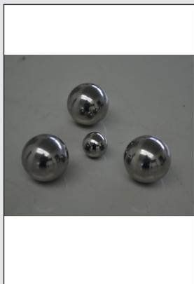
Le jeu de billes utilisé contient 4 billes en acier présentant un diamètre défini. Ces billes permettent de calibrer le volume libre de la bouteille de pression.
