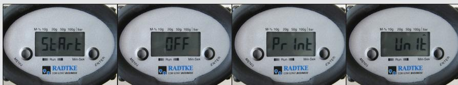
Pour naviguer entre les différentes commandes par menu du manomètre, appuyer à chaque fois sur la touche « Menu ». La commande sélectionnée est alors affichée. Appuyer sur la touche « ENTER » pour exécuter la commande affichée. En l'absence d'une confirmation de la commande dans les 7 secondes, l'écran revient à l'affichage standard: la dernière valeur de mesure.
