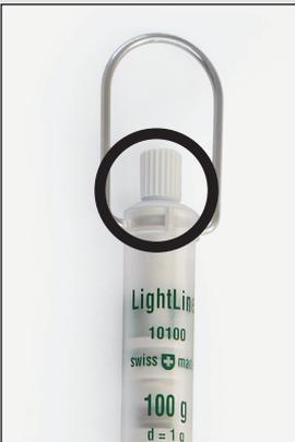
**Tarage / lecture:** mettre un gobelet à échantillon vide et propre en place. Ajuster le point zéro en tournant la vis de tarage blanche (cercle noir). Vous devez avoir les yeux à hauteur de l'échelle de manière à réduire le risque d'erreurs de lecture.
