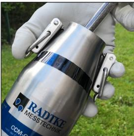
Durch Schütteln des CM-Gerätes werden die Ampullen zertrümmert und die freigesetzten Reagenzien kommen miteinander in Kontakt. **Die Reaktion ist in der Regel in 1 Minute abgeschlossen, wenn Sie die Flasche horizontal rotierend hin und her bewegen.**
