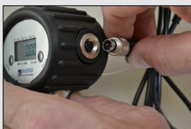
Schliessen Sie das Kabel auch am Manometer an und lösen Sie den **Print**-Befehl am Manometer aus. Sie können beliebig viele Protokolle von der letzten Messung ausdrucken.
