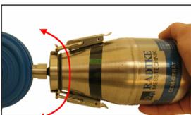
Die Messung ist beendet, wenn der Druck konstant ist. Das hängt wesentlich von der Intensität des Schüttelns ab und ist, abhängig vom Probenmaterial, typischerweise nach 10-Minuten (Timer) erreicht. Die Druckflasche wird zur Kontrolle nochmals kurz geschüttelt. Bleibt der Druck unverändert, kann die Messung als abgeschlossen betrachtet werden.
