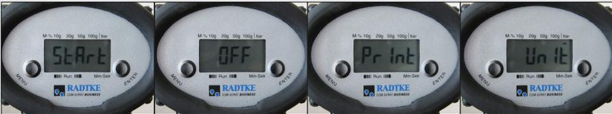
Um sich durch die Menubefehle des Manometers zu bewegen, drücken Sie jeweils die «Menu»-Taste. Der jeweils angewählte Befehl wird angezeigt. Um den angewählten Befehl auszuführen, muss er mit der «ENTER» Taste bestätigt werden. Wird der Befehl nach 7 Sekunden nicht bestätigt, geht die Anzeige in die Standardanzeige zurück: Letzter Messwert.
