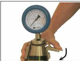
Die Druckflasche wird mit dem Deckel verschlossen. Stellen Sie den Timer (bei CLASSIC Ausstattungen beiliegend) auf 10:05 Minuten: Sekunden, starten ihn und schütteln Sie bei Erreichen der Zeit 10:00 kräftig die Druckflasche. Mit dem Zertrümmern der Ampulle beginnt die chemische Reaktion.
