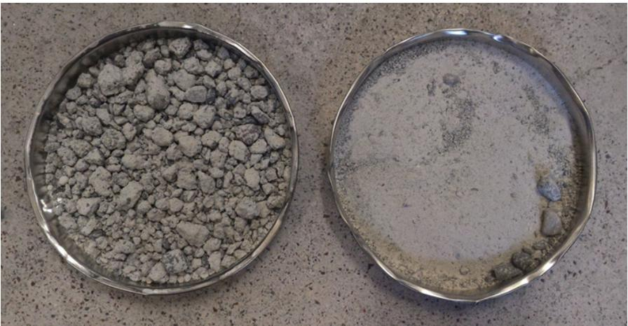
50 g Probe vor resp. nach der Vorzerkleinerung mit dem Zerkleinerungsstab
