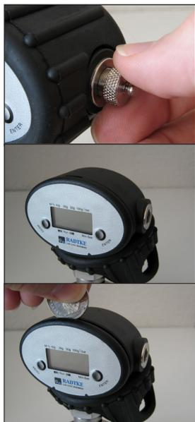
Dazu muss die Abdeckung der Schnittstelle abgeschraubt sowie die Gummischutzkappe heruntergezogen werden.
