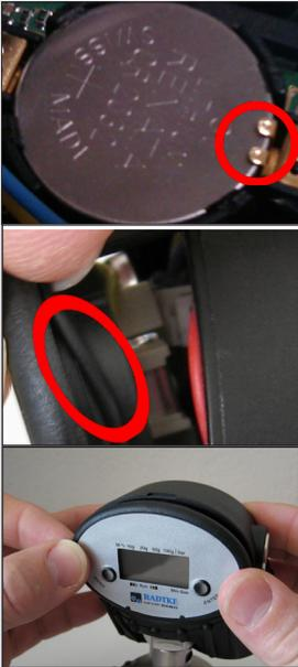
Die alte Batterie vorsichtig herausnehmen. Die neue Batterie ist zuerst bei den beiden Kontakten anzusetzen (roter Kreis) und anschliessend vorsichtig in die Arretierungen rein zudrücken.
