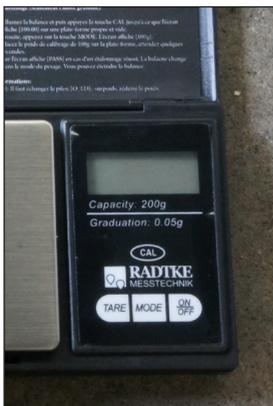
La báscula se apaga después de 120 segundos automáticamente, o presione el botón ON/OFF durante más de 3 segundos.
