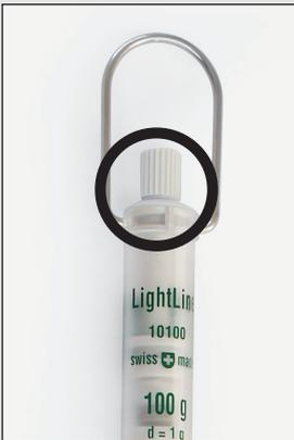
**Tara / Lectura:** Colocar un recipiente de muestras vacío y limpio. Ajustar el punto cero girando el tornillo de tara blanco (círculo negro). Los ojos deben situarse para ello a la altura de la escala con el fin de minimizar los errores de lectura.
