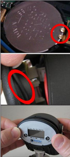
Retirar la batería antigua cuidadosamente. La nueva batería debe colocarse primero por el lado de los contactos (círculo rojo) y a continuación presionarse hacia adentro cuidadosamente en los encastres.
