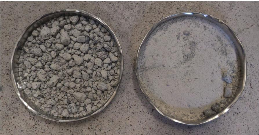
50 g de muestra respectivamente antes y después de la trituración previa con la varilla de trituración.
