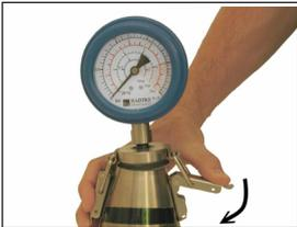
Cierre el cilindro de presión con la tapa. Ajuste el temporizador (incluido en el equipo CLASSIC) en 10:05 (minutos:segundos), póngalo en marcha y agite enérgicamente el cilindro de presión cuando se alcance el tiempo 10:00. Al romper la ampolla comienza la reacción química.
