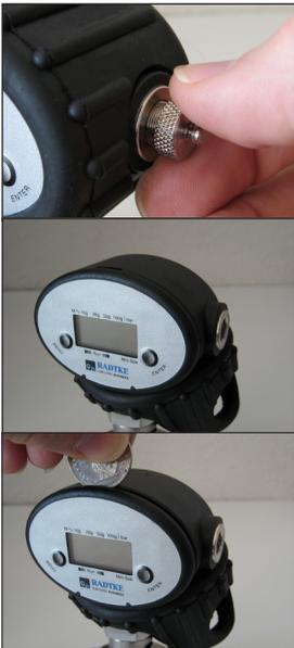
Para ello debe desatornillarse la cubierta de la interfaz, así como retirarse hacia abajo el capuchón de protección de goma.
