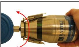
La medición finaliza cuando la presión es constante. Esto depende en gran medida de la intensidad de agitación y, en función del material de muestra, suele alcanzarse al cabo de 10 minutos (temporizador). A modo de control, volver a agitar brevemente el cilindro de presión. Si la presión se mantiene constante, la medición puede considerarse finalizada.
