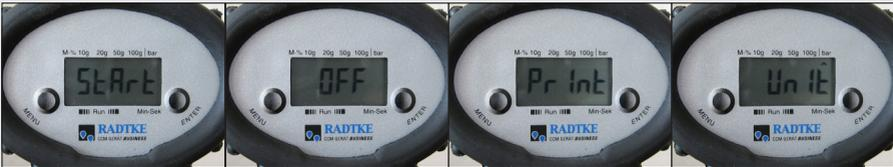
Para moverse por las opciones de menú del manómetro, presione respectivamente el botón «Menu». Se muestra el comando respectivamente seleccionado. Para ejecutar el comando seleccionado, debe confirmarse con el botón «ENTER». Si el comando no se confirma en un plazo de 7 segundos, la indicación vuelve a la indicación estándar: Último valor de medición.
