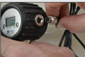
Conecte el cable también al manómetro y active el comando **Print** en el manómetro. Puede imprimir tantos protocolos de la última medición como desee.
