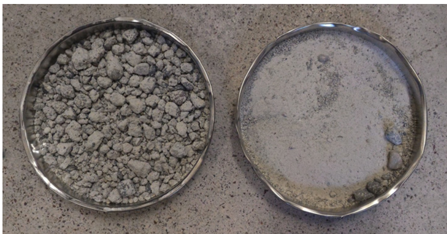
50 g-monster voor, resp. na het voorvergruizen met de roerstaaf
