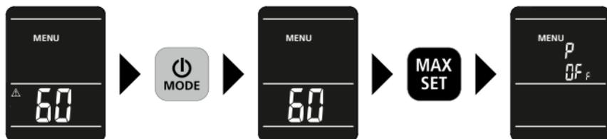
L'appareil dispose d'un arrêt automatique. Il peut avoir lieu après 3 minutes ou 60 minutes. Il est judicieux de régler l'arrêt automatique après 60 minutes pour utiliser l'appareil comme hygromètre pour surveiller le climat ambiant.
