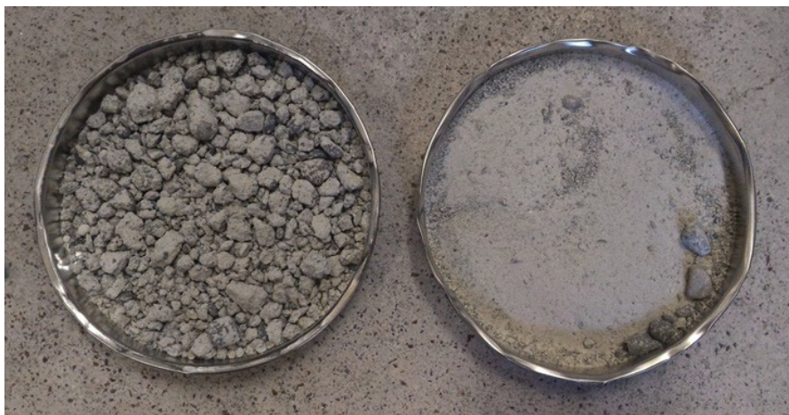
50 g vzorku před resp. po předběžném drcení drticí tyčí
